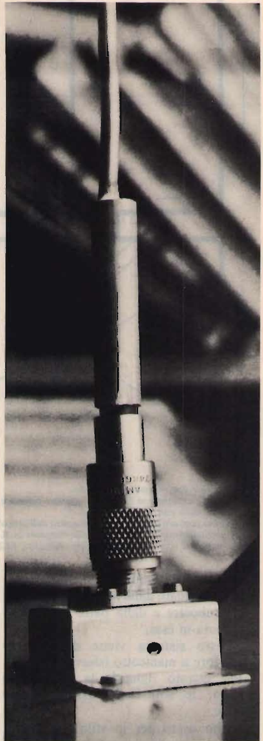
figura 3 Foto della base dell'antenna.
